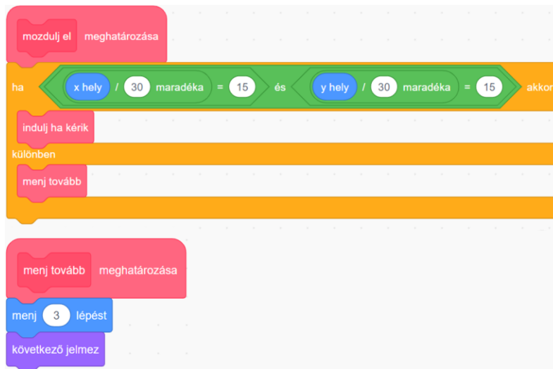
3. ábra: Az Egér irányítását megvalósító eljárás (fent), és a két eset közül a másodikat megvalósító eljárás (lent).
