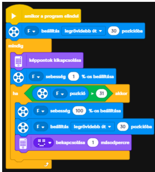
7. ábra: A következő feladatot megvalósító program kódja látható a képen: az érintésérzékelőként működő motor ha „benyomódik”, akkor mosolygó fej jelenik meg a kijelzőn 10 .
