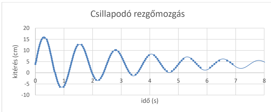
8. ábra: A csillapodó rezgőmozgás grafikonja
