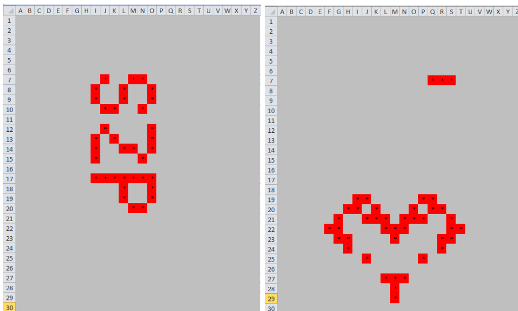
4. ábra: A Conway-féle „életjáték” illusztrálása – egy táblázatkezelőben készített szimuláció; a sejtér kezdő és a 41. lépésbeli állapota.
